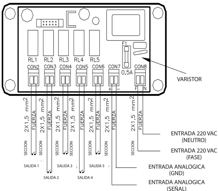
NOTA: LAS SALIDAS DE CADA RELÉ DEBEN CONTROLAR LAS BOBINAS DE CONTACTORES Y NO MANEJAR DIRECTAMENTE LOS GRUPOS DE VENTILADORES
