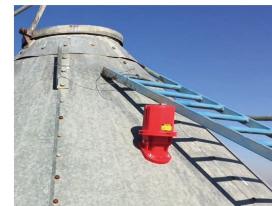
Dispositivo SiloMetric Instalado en la parte superior de silos
