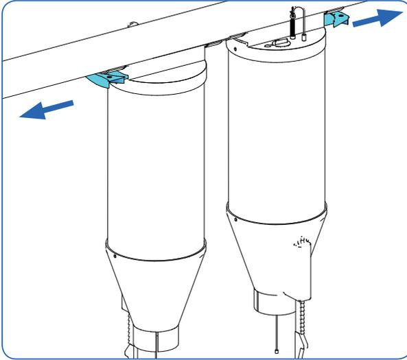
El dosificador hay que sujetarlo con bridas, ya sean de nylon o metálicas. Apretar lo suficiente para que no quede hueco entre el tubo de alimentación y la unión con la tapa superior.
