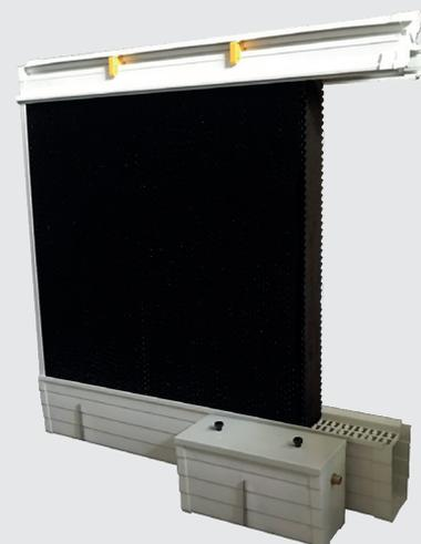
Los paneles de plástico trabajan de la misma manera que los de celulosa, basando su funcionamiento en el enfriamiento evaporativo por caída de agua sobre una superficie de celdas que retiene temporalmente el agua, por la que pasa el aire, aumentando la humedad relativa y disminuyendo la temperatura. Este paso de aire provoca la evaporación y enfriamiento de la sala
