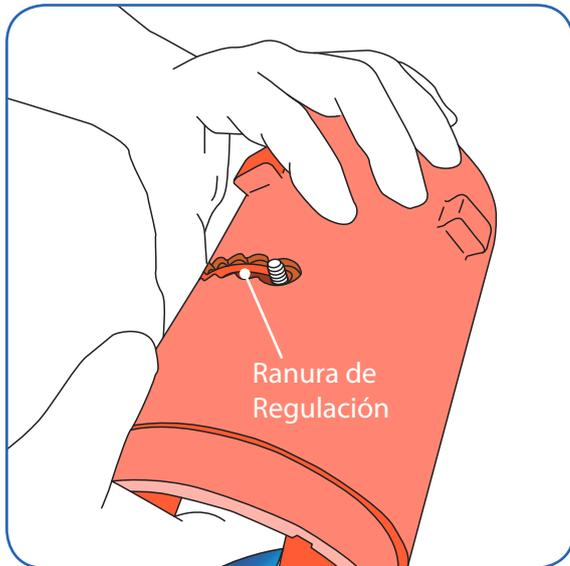
**5-** Una vez posicionado el Regulador (02) debemos soltar unos milímetros el tornillo y girar el Regulador (02) en sentido anti-horario haciendo encajar la ranura helicoidal del Regulador (02) con la ranura del Envoltorio (01) hasta que se asome el tornillo por la ranura de regulación.
