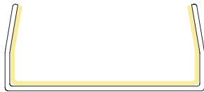
Fig. 149. Siliconado del interior de los perfiles.
