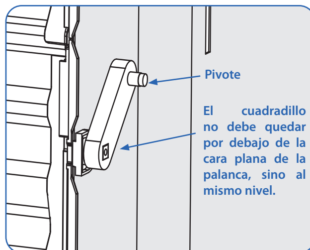
Fig. 118. La palanca y la pinza quedan a la misma altura.
