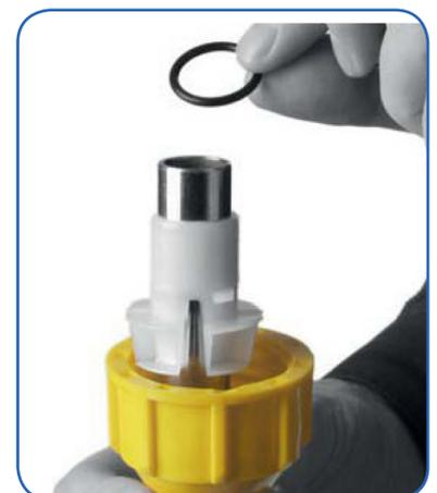
PASO 9: La junta tórica se coloca en el tubo.
