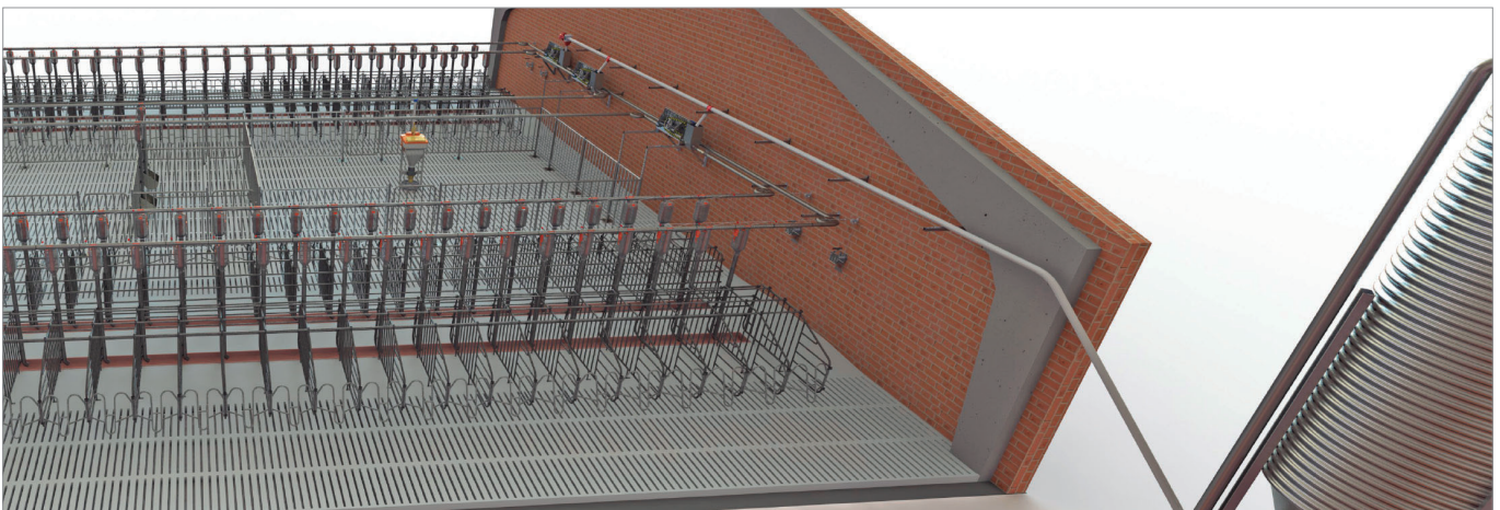
Sistema de reparto de pienso combinado, mediante transporte por espiral desde el silo a los circuitos de cadena.
