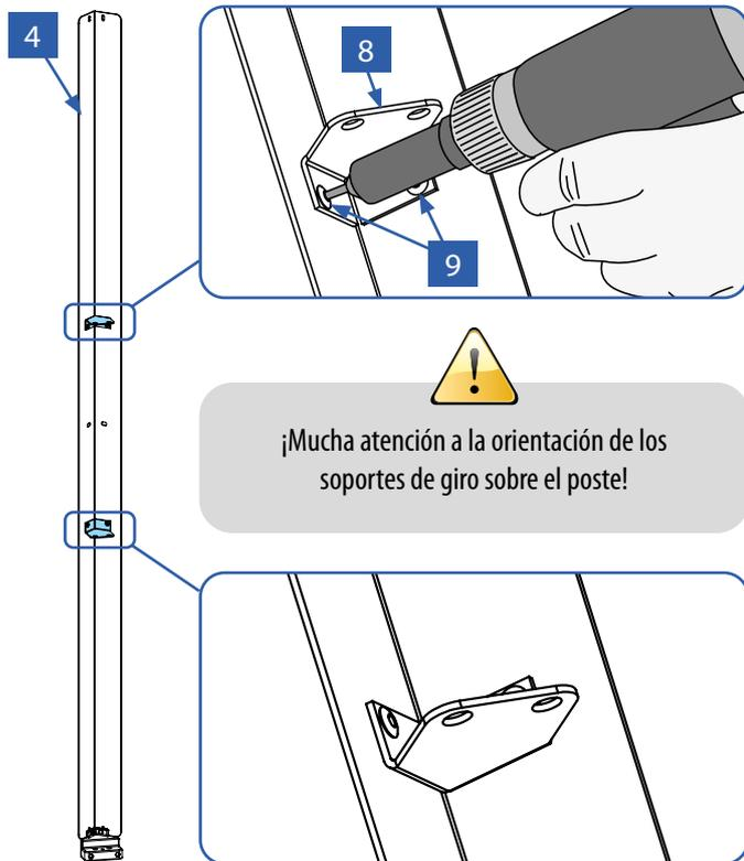
Fig. 10.4. Remachado de los soportes de giro.
