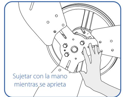
Fig. 8.6. Vista trasera montaje de al hélice.
