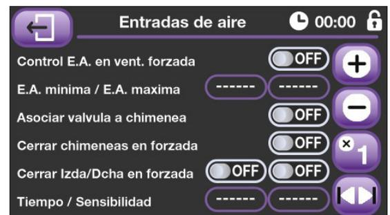
si cuando los ventiladores estén parados las válvulas permanecen cerradas, o no. A continuación, indicamos al equipo que entradas de aire deben permanecer abiertas o cerradas en régimen de ventilación forzada.
