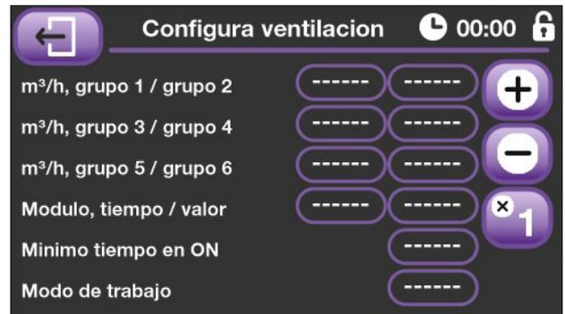
momento sin la necesidad de tener conectados continuamente los ventiladores a un poder de extracción inferior al que pueden dar (ventilaciones reguladas). Para ello nuestros equipos permiten programar un tiempo de ciclo de trabajo, que puede variar en función del tipo de ventiladores empleados y dentro de dicho ciclo se calcularán los tiempos de encendido y apagado necesarios.
