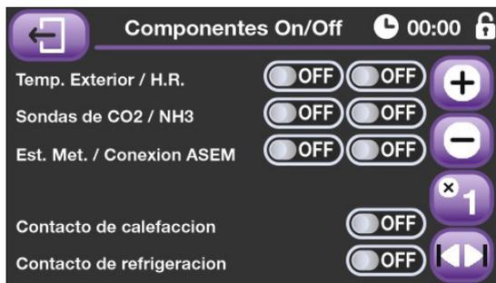
En la primera pantalla de configuración nos encontramos con el control de selección de componentes activos del equipo. En primer lugar, indicamos al equipo los sensores que tenemos conectados a él. La opción conexión ASEM nos indica si el valor de la temperatura exterior y el de la estación meteorológica nos viene por el bucle o no.
