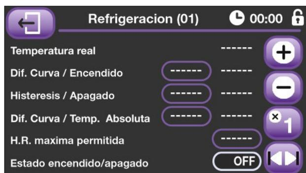
En estas pantallas aparecen los datos de trabajo programados para el control de la refrigeración, aquí se puede programar la diferencia con la curva para calcular la “**Temperatura de encendido**” (por encima de ella el sistema de refrigeración empieza a funcionar), también podemos programar la histéresis de desconexión para calcular la “**Temperatura de apagado**” (por debajo de ella la refrigeración permanecerá siempre apagada).
