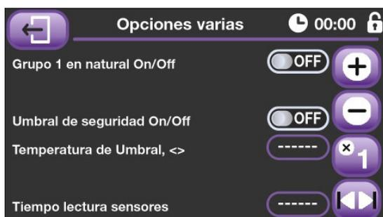
En la tercera pantalla tenemos opción a programar parámetros especiales de trabajo. En primer lugar, tenemos la posibilidad de indicar al equipo si el grupo 1 de ventilación permanece conectado en ventilación natural o no. El umbral de seguridad es una temperatura que sumada a la temperatura deseada marcará un valor que de ser alcanzado por la temperatura media forzará a abrir ventanas y chimeneas por seguridad.
