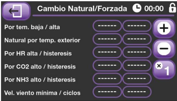
Las tres líneas siguientes nos permiten marcar unos niveles de valor máximo de los sensores ambientales para que estos fuercen el cambio a ventilación forzada por exceso de humedad o gases dañinos dentro de la nave.
