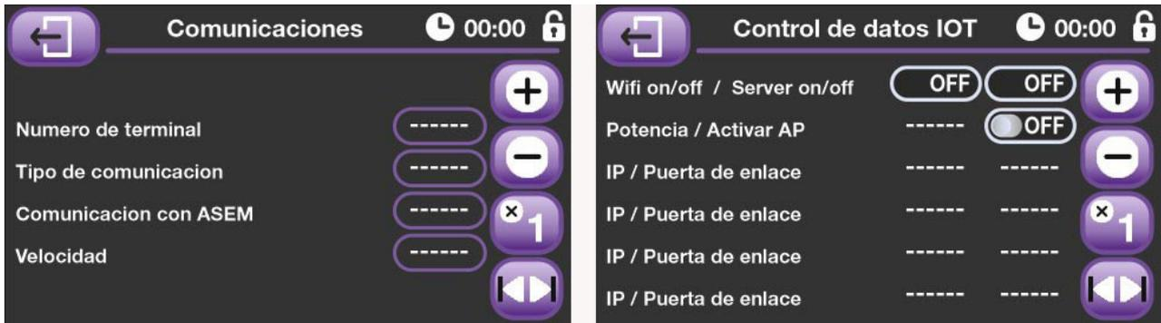
En la primera pantalla podemos programar los dos datos referentes a las comunicaciones por bucle, el número de terminal en red que se le asigna a este equipo, el tipo de comunicaciones, y también indicamos si las señales de estación meteorológica y temperatura exterior le serán entregadas al equipo a través del bucle.
