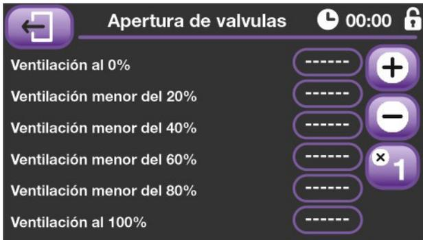
Las válvulas de chimenea no deben tener una apertura proporcional a la velocidad de los ventiladores. Mediante esta pantalla podemos ajustar la apertura de las válvulas en función del % de trabajo de los ventiladores; lo lógico es que la válvula siempre esté un % bastante más abierta que el % de trabajo del ventilador.
