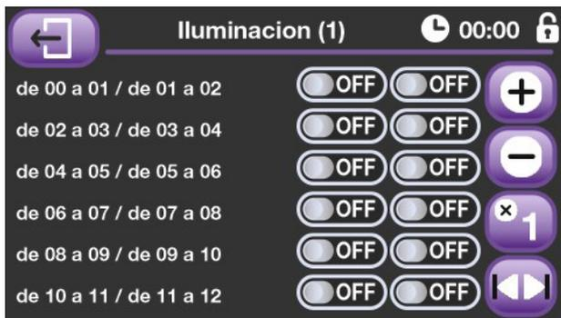
Mediante las dos pantallas de control de iluminaciónreloj se nos da la posibilidad de manejar el sistema de luz de la salacontrolar una salida digital, (todo/nada) para uso genérico, quedando el día dividido en fracciones de una hora y pudiendo seleccionar el encendido / apagado del sistema de iluminación de la sala. reloj.
