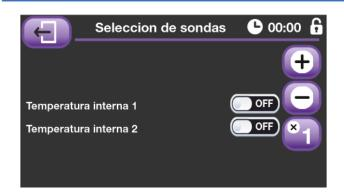
Aquí se nos permite indicar si el equipo trabajara con una o dos sondas de temperatura y en caso de trabajar con una a que entrada de sondas la tenemos conectada.
