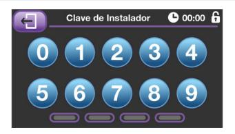
Una vez en el Menú de Instaladores es posible cambiar la clave de instalador pulsando en el botón de cambio de clave de instalador, tras lo cual se accederá a la primera pantalla de cambio de clave de instalador, donde se pedirá la nueva clave de instalador deseada. Una vez introducida la nueva clave en la pantalla anterior, se requerirá que se repita la misma por motivos de seguridad.
