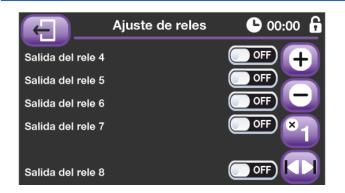
Ésta es la pantalla de pruebas de las salidas digitales, al igual que en el caso anterior, podemos programar las salidas a nuestro antojo, para poder realizar pruebas de funcionamiento del equipo o sus periféricos.
