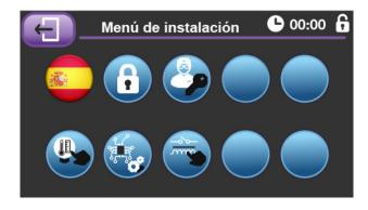
Si se introduce la clave correcta se dará acceso a la pantalla de menú de instalador, a partir de la cual se puede acceder a las pantallas de puesta en marcha y comprobación del equipo.
