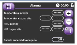
En esta pantalla podemos programar los datos de las diferentes alarmas. Tenemos dos temperaturas a programar una para el control del exceso de temperatura y otra para la falta de la misma. De la misma forma, tenemos dos humedades a programar una para el control del exceso de humedad y otra para la falta de la misma.
