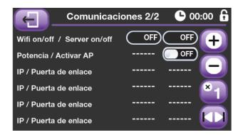
En esta pantalla podemos ver los datos de conexión wifi de nuestro equipo, es una pantalla informativa de cara a ayudar al servicio técnico ante un posible error de comunicaciones con los sistemas inalámbricos de la instalación. Mediante la opción "Activar AP", podemos generar un forzado de reconexión del equipo al sistema.
