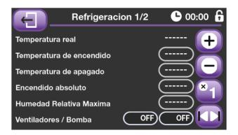
En estas pantallas nos aparecen los datos de trabajo programados para el control de la refrigeración, aquí podremos programar la temperatura de encendido (por encima de ella el sistema de refrigeración empieza a funcionar), la temperatura de apagado (por debajo de ella la refrigeración permanecerá siempre apagada).
