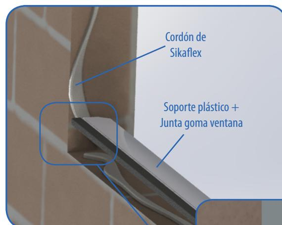
**Fig. 04.** Posicionamiento del soporte.
