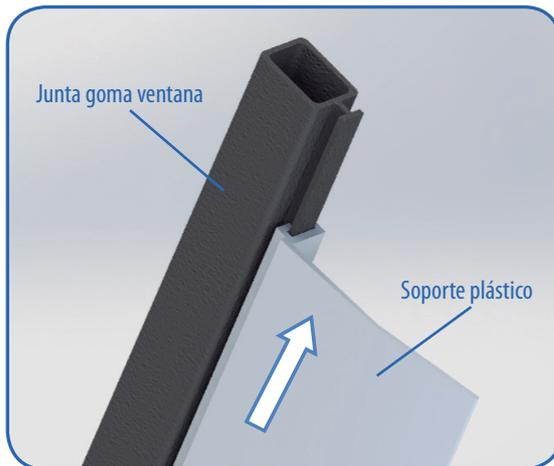
**Fig. 01.** Detalle del montaje de la junta de goma en el soporte plástico.
