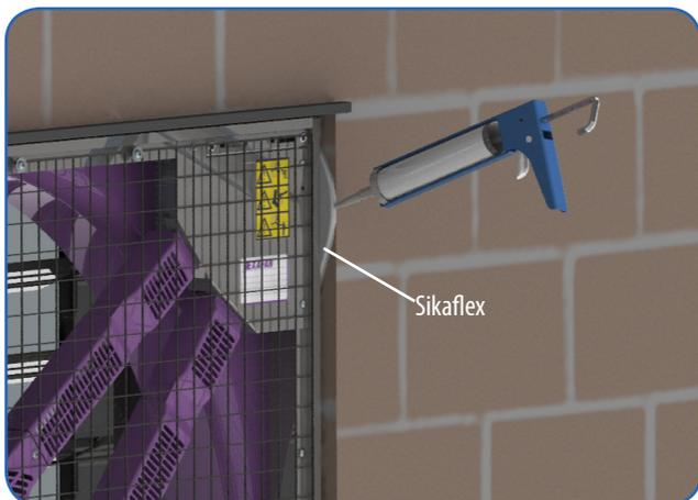
Fig. 10. Detalle de la colocación de Sikaflex en las juntas entre el ventilador y el soporte.
