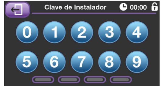
Si se introduce la clave correcta se dará acceso a la pantalla de menú de instalador, a partir de la cual se puede acceder a las pantallas de puesta en marcha y comprobación del equipo.
