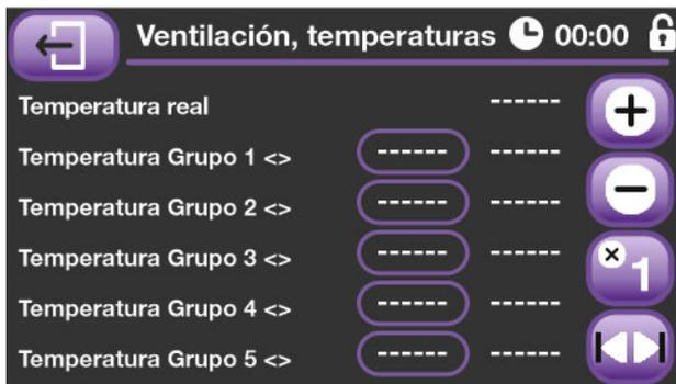
Esta es la pantalla de control de los datos de ventilación. En ella podemos programar una diferencia de temperatura para cada grupo de ventilación, que aplicada al valor de temperatura deseada de la curva nos dará la temperatura deseada de conexión al 100% de cada grupo.
