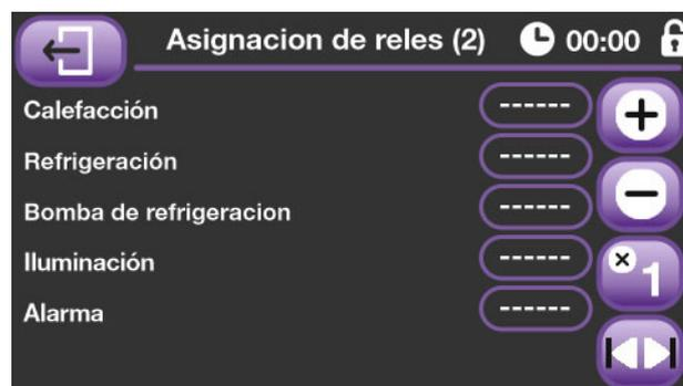
Las pantallas de esta sección están destinadas a seleccionar el relé de salida que asignamos a cada uno de los componentes en uso. El relé 8 queda reservado para el control de la alarma, por tratarse del único que nos permite utilizar sus tres contactos y además tenerlos disponibles de forma libre y totalmente independiente de los demás.
