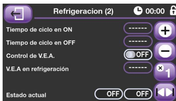
También se nos permite modificar la velocidad de entrada de aire a la sala para poder adaptar el sistema de refrigeración a su máximo rendimiento.
