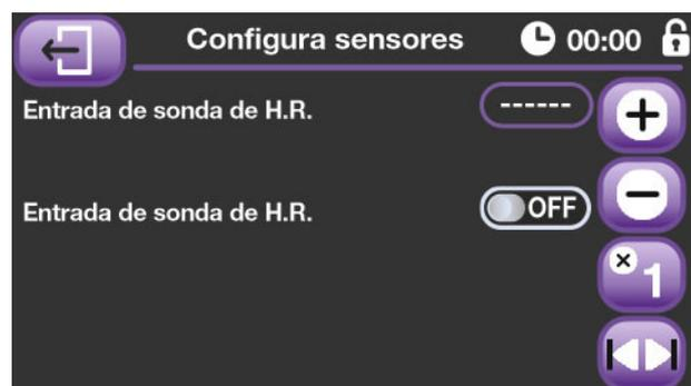
Esta es la pantalla donde indicamos el tipo de sensor que hemos conectado al equipo, 0/5V, 0/10V, etc.
