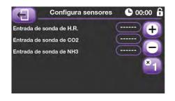
Ésta es la pantalla donde indicamos el tipo de sensor que hemos conectado al equipo, 0/5V, 0/10V, etc.
