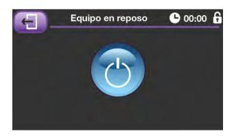
En el estado de reposo el equipo no realiza ningún tipo de acción externa, es decir, se siguen realizando operaciones de lectura de sondas, cálculos, etc., pero todas las salidas permanecen en estado de reposo y el relé de alarma permanece siempre activo para no provocar falsas alarmas en la explotación.
