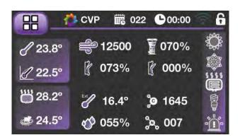
Ésta es la pantalla de inicio del equipo, en la misma se muestran los diferentes valores de trabajo, temperatura, humedad, ventilación y entrada de aire.
