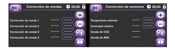
En estas dos pantallas se nos da la posibilidad de programar los datos referentes al ajuste de las sondas y sensores de nuestra sala. Los equipos salen calibrados de fábrica pero debido a la carga que pueda suponer la instalación sobre la lectura de un sensor se pueden obtener lecturas con ligeros errores que podemos calibrar mediante estas pantallas.
