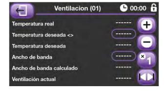
Ésta es la pantalla de control de los datos de ventilación. En ella podemos programar una diferencia de temperatura que aplicada al valor de temperatura deseada de la curva nos dará la temperatura deseada de ventilación.
