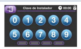
Si se introduce la clave correcta se dará acceso a la pantalla de menú de instalador, a partir de la cual se puede acceder a las pantallas de puesta en marcha y comprobación del equipo.
