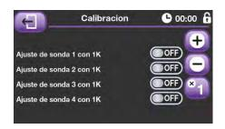
Mediante la pantalla de Calibración de sondas se calibran los circuitos de entrada de sondas de temperatura con un ajuste de 1K (proceso que se iniciará al pulsar el interruptor deslizante, por lo cual será necesario tener conectada la sonda de calibración de 1K).
