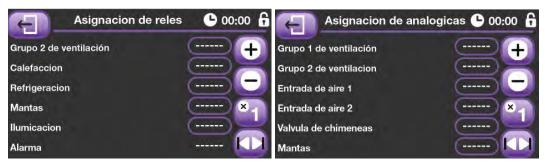
Las dos pantallas de esta sección están destinadas a seleccionar los relés y señales analógicas de salida que asignamos a cada uno de los componentes en uso. El relé 8 queda reservado para el control de la alarma, por tratarse del único que nos permite utilizar sus tres contactos y además tenerlos disponibles de forma libre y totalmente independiente de los demás.
