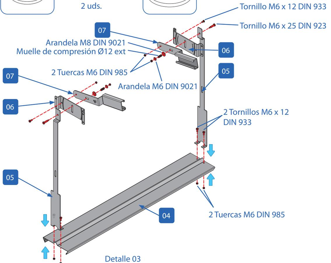
**Paso 4:** Insertaremos en la tolva todo lo ensamblado en el paso 3 y lo fijaremos colocando los tornillos, arandelas, tuercas y muelles tal y como indica los dibujos que mostramos a continuación. (Ver detalle 04).
