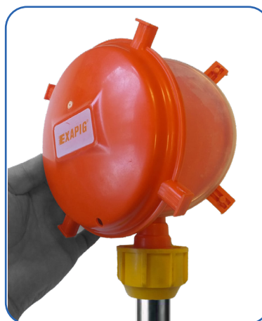
PASO 8: Tapa colocada encima de la membrana.
