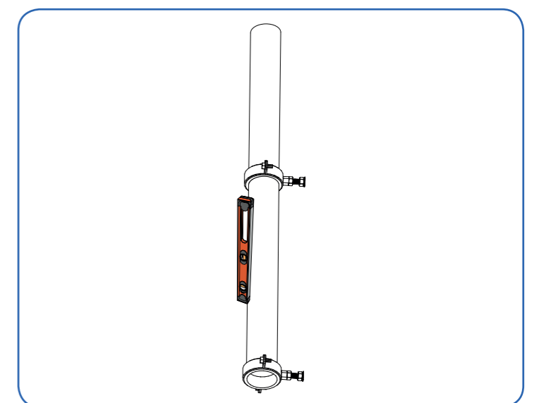
Fig. 18. El tubo debe quedar perfectamente nivelado y alineado una vez cerradas las abrazaderas.
