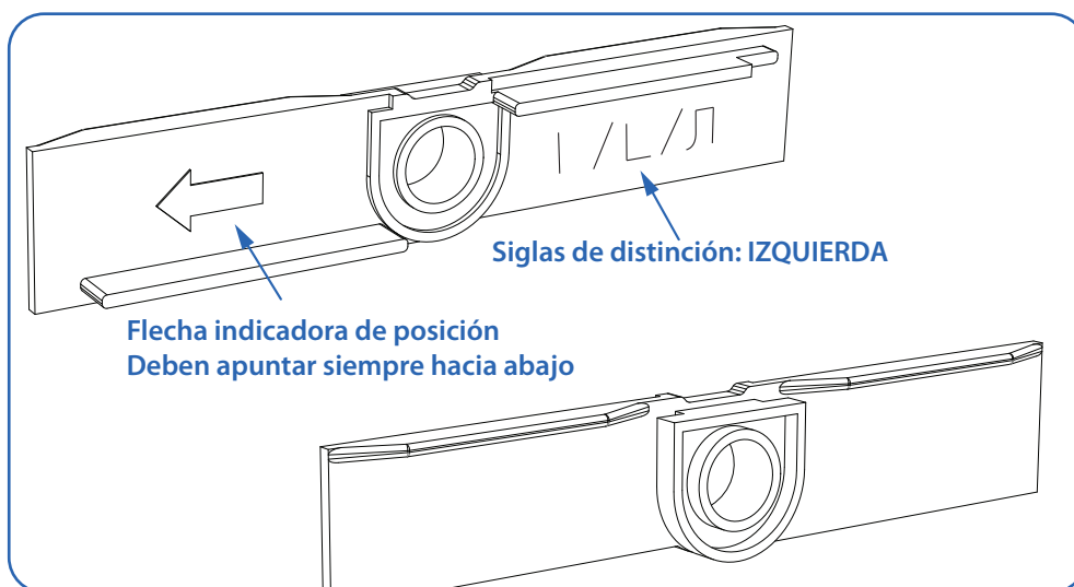
Fig. 108. Cierre pinza lama izquierda.
