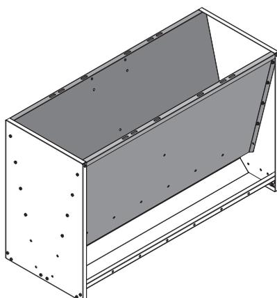
**Paso 3:** Una vez ajustados los laterales (02) y los frontales (03) y apretados todos los tornillos, colocar las guías en "U" de la tajadera (04), dos por la parte delantera y dos por la parte trasera. Cada guía (04) tiene dos pernos soldados en sus extremos que hay que atravesar por los orificios y apretar con una tuerca en la parte exterior.
