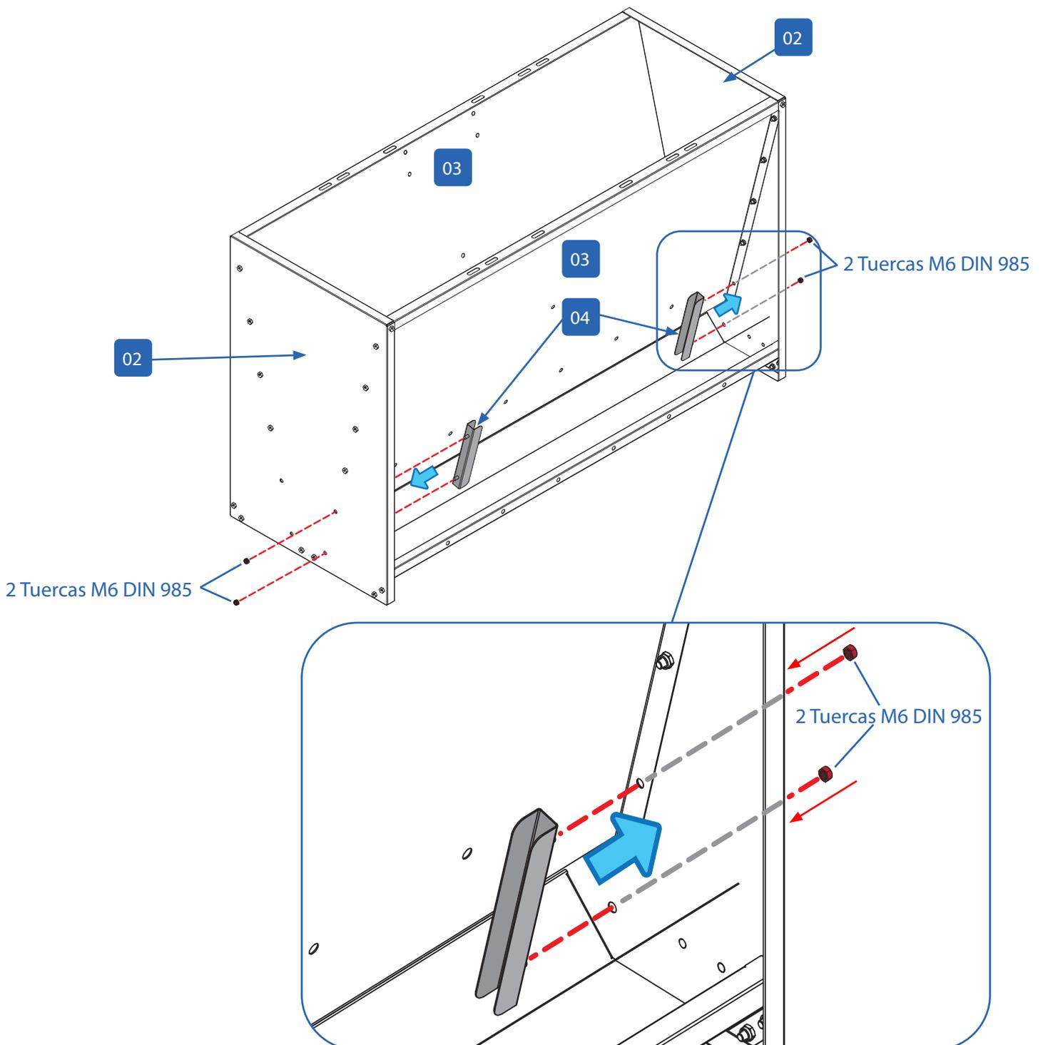
Repetir la misma acción en la parte trasera de la tolva para posicionar las otras dos guías (04).
