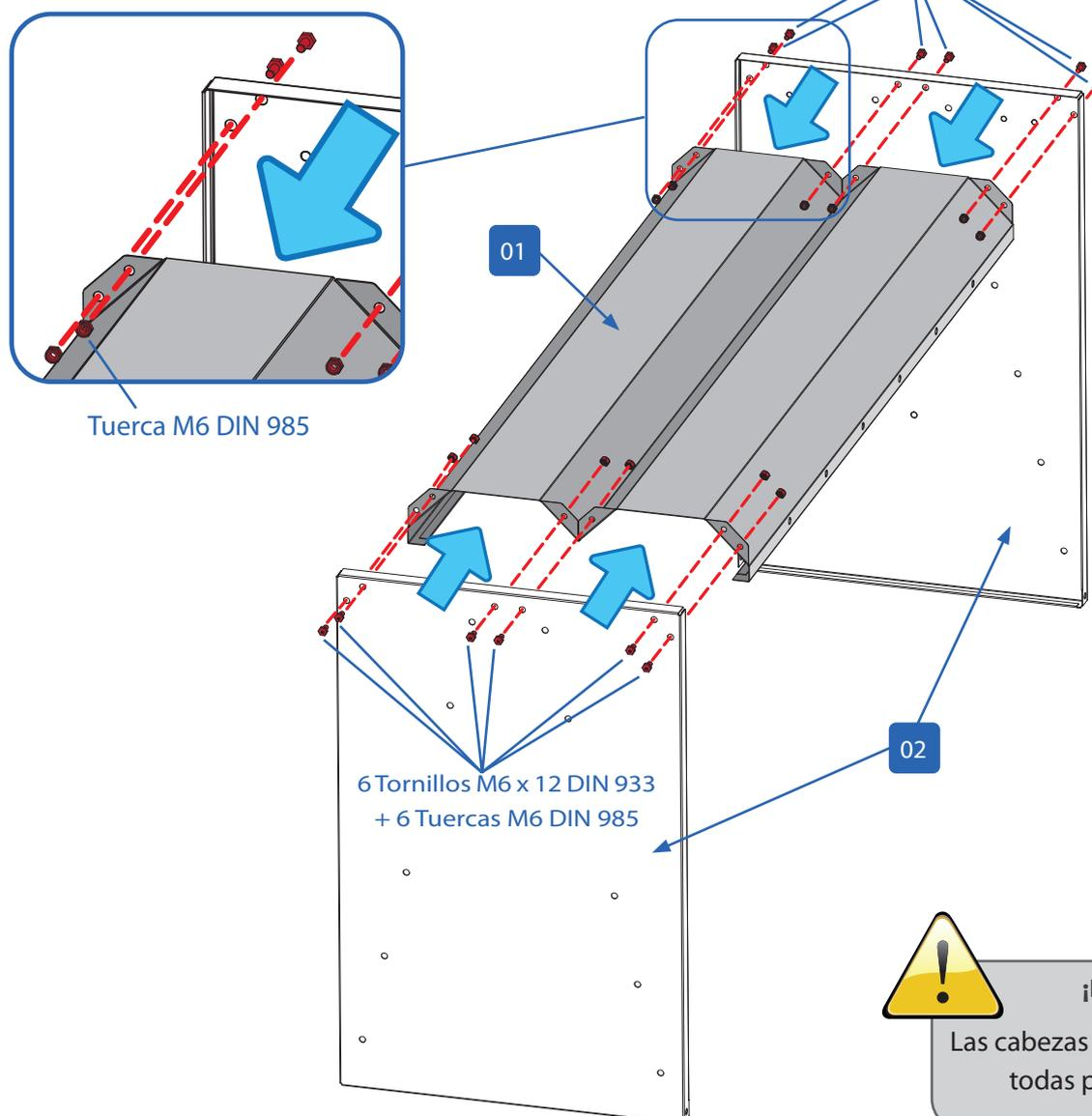
**Paso2:** Para colocar las dos chapas frontales (03) se gira la tolva 180°. Insertar las tapas frontales dentro de la tolva, una por la parte frontal y la otra por la parte trasera. Cuando se realice esta operación hay que asegurarse que el panel frontal queda situado detrás de los agujeros para la guía en "U". Los agujeros en las chapas laterales (2) deben coincidir con los agujeros de las solapas de las piezas frontales (03).
