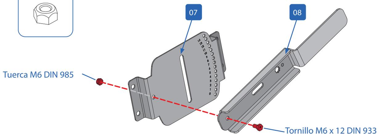
Repetir la misma acción con la otra chapa y la otra palanca.
