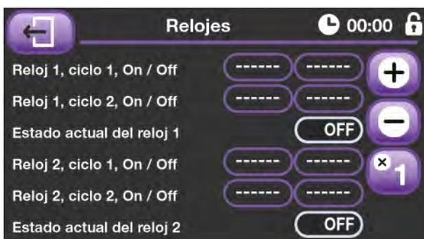
Mediante esta pantalla accedemos al control de dos relojes para usos varios. Como podemos observar cada reloj tiene dos ciclos de trabajo, (hora de inicio de ciclo y hora de fin), y pueden ser programados libremente y empleados para racionamientos de agua o pienso, iluminación, etc.
