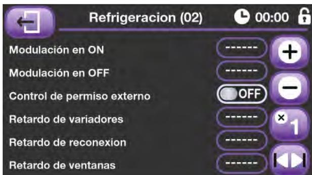
Pulsando la tecla de cambio de pantalla accedemos a los datos auxiliares del control de refrigeración. Aquí se pueden programar unos tiempos de encendido y apagado que corresponden al funcionamiento del sistema cuando la temperatura actual esté comprendida entre la temperatura de encendido y la temperatura absoluta.
