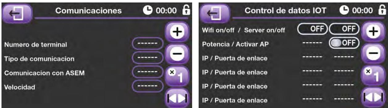
En la primera pantalla podemos programar los dos datos referentes a las comunicaciones por bucle, el número de terminal en red que se le asigna a este equipo, el tipo de comunicaciones y también indicamos si las señales de estación meteorológica y temperatura exterior le serán entregadas al equipo a través del bucle.
