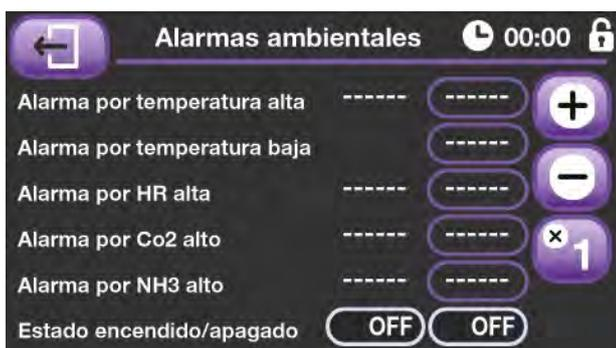
En esta pantalla se puede programar los datos de las alarmas ambientales. Existen dos temperaturas a programar, una para el control del exceso de temperatura y otra para la falta de la misma.
