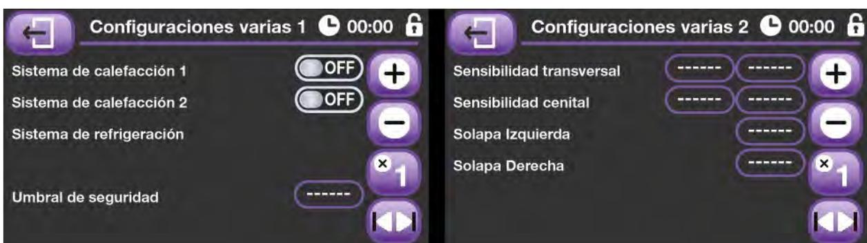
Mediante estas dos pantallas podemos programar diferentes opciones de la forma de trabajo del sistema. En la primera indicamos al equipo si deseamos realizar un control de calefacciones y la refrigeración. También podemos programar una temperatura de umbral de seguridad, de forma que si la temperatura media alcanza ese valor se abran todas las ventanas y chimeneas.
