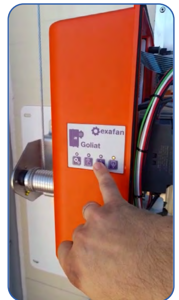
7º. Volver a pulsar la tecla automático pero esta vez sólo un toque.
