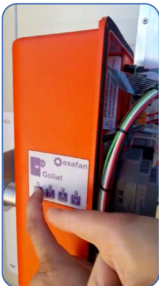
4º. Soltar la tecla después de 5 segundos pulsada.
